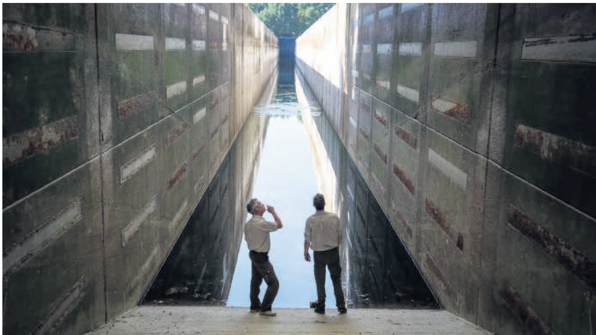
De golventestbak in het Waterloopbos waar Zeeuwse stormen konden worden nagebootst. FOTO JÖRGEN CARIS
